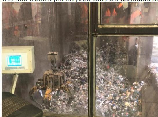
Avant d'être incinérés, les déchets sont mélangés dans la fosse pour faciliter la combustion : soit car ils peuvent être trop humides, soit trop chauds et il faut éviter les départs d'incendie.
